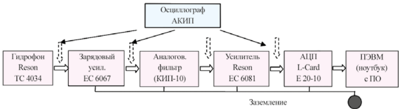
Рис. 1. Схема включения аппаратуры программно-аппаратного измерительного комплекса в приемный канал
