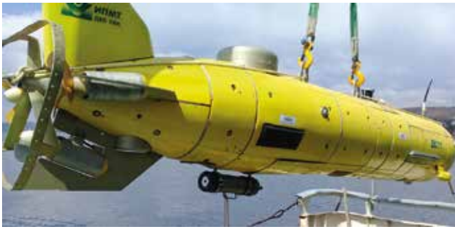
Рис. 1. АНПА «ММТ-3000» с автономным гидрофонным устройством
