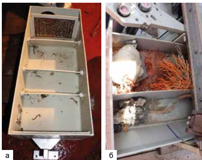
Рис. 2. Контейнер всасывающего устройства (а); контейнер скида с биологическими образцами (б)
