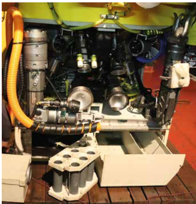
Рис. 1. ТНПА «Comanche 18», оборудованный скидом с пробоотборниками
