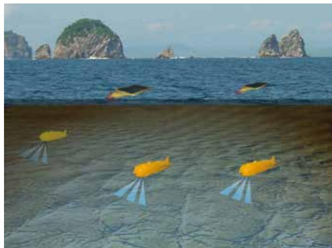
Рис. 3. Организация навигации группы АНПА при помощи двух аппаратов, оборудованных солнечными панелями (SAUV)
