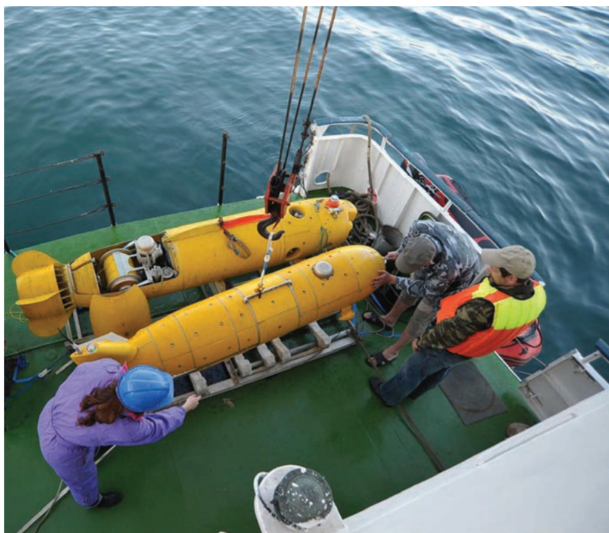
Рис.2. Демонстрация АНПА «ММТ-3000» и автономно-привязного аппарата «TSL» на борту НИС «Юрий Молоков»
