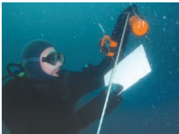
Рис. 2. «Пингер» – передатчик на буйрепе и приёмник на руке водолаза
