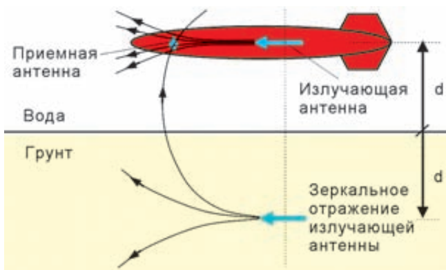
Рис. 2. Возникновение помехи от грунта в активном электромагнитном искателе
