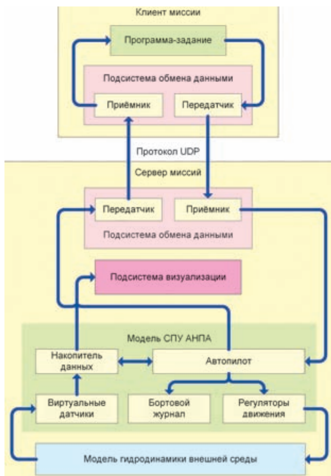
Рис. 3. Схема потоков данных в клиент-серверной архитектуре симулятора миссий
