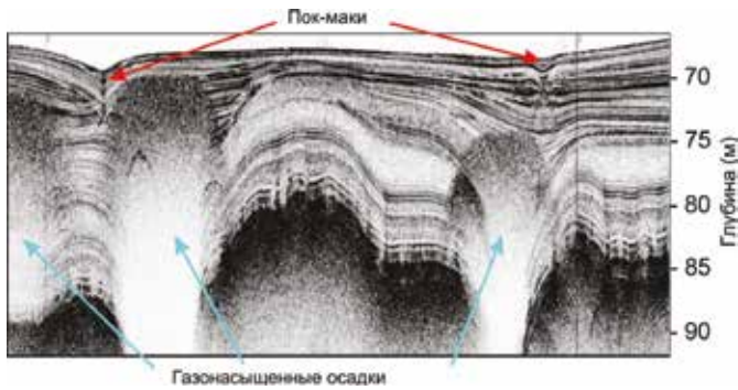
Рис. 1. Покмарки (район о-ва Гогланд) на записи непрерывного сейсмоакустического профилирования (НСП). Совместный рейс ВСЕГЕИ и Геологической службы Финляндии на НИС «Аранда» (2009 г.) [22].
