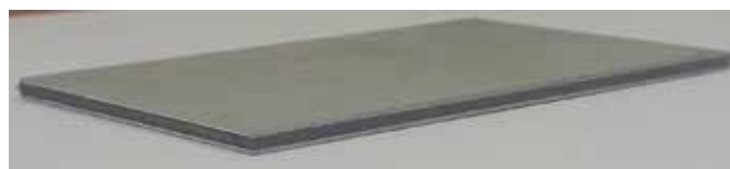
Рис. 7. Активный элемент на основе пьезоактивной пленки Ф-2МЭ
