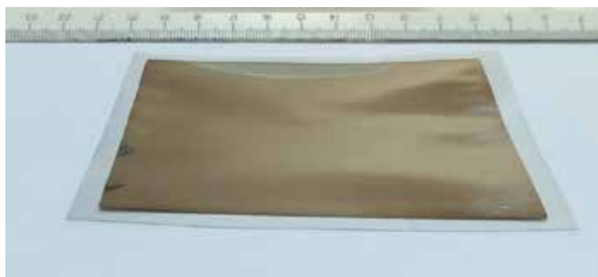
Рис. 6. Пьезоактивная пленка из ПВДФ марки Ф-2МЭ с металлическим токопроводящим покрытием
