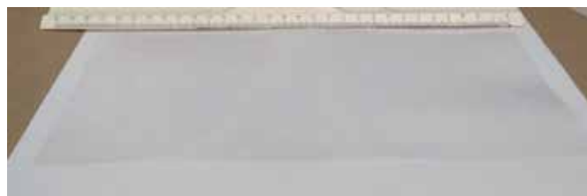
Рис. 5. Пьезоактивная пленка из ПВДФ марки Ф-2МЭ
