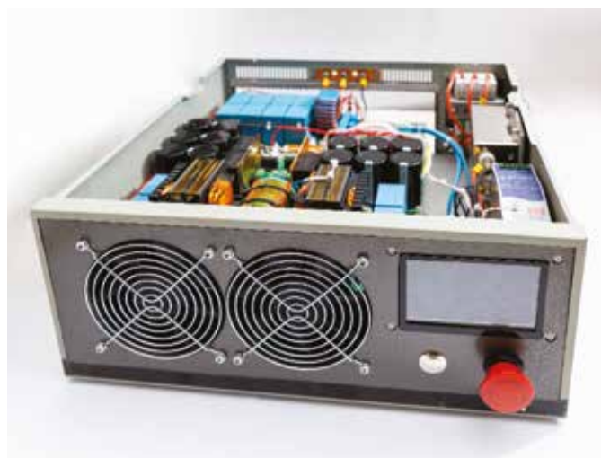
Рис. 6. Внешний вид одного модуля мощностью 20 кВт наборной части СЭП
