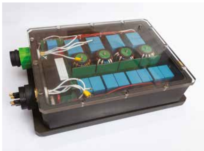
Рис. 4. Внешний вид понижающего преобразователя постоянного тока мощностью 20 кВт
