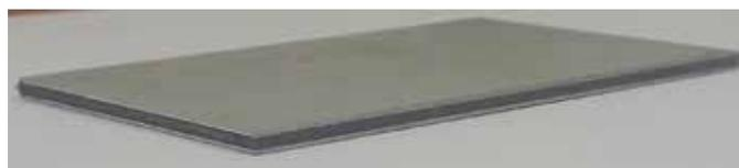
Рис. 7. Активный элемент на основе пьезоактивной пленки Ф-2МЭ
