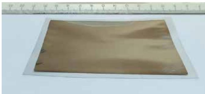
Рис. 6. Пьезоактивная пленка из ПВДФ марки Ф-2МЭ с металлическим токопроводящим покрытием
