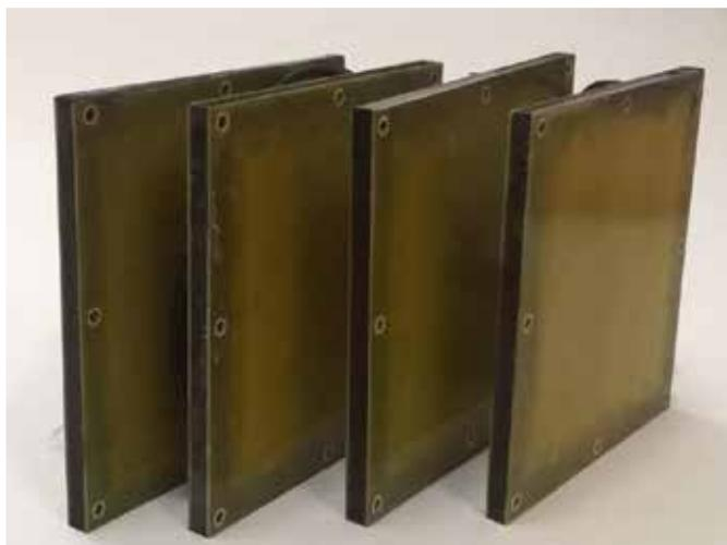
Рис. 8. Вариант исполнения ЭАП на основе пьезоактивной пленки Ф-2МЭ.
