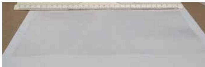
Рис. 5. Пьезоактивная пленка из ПВДФ марки Ф-2МЭ
