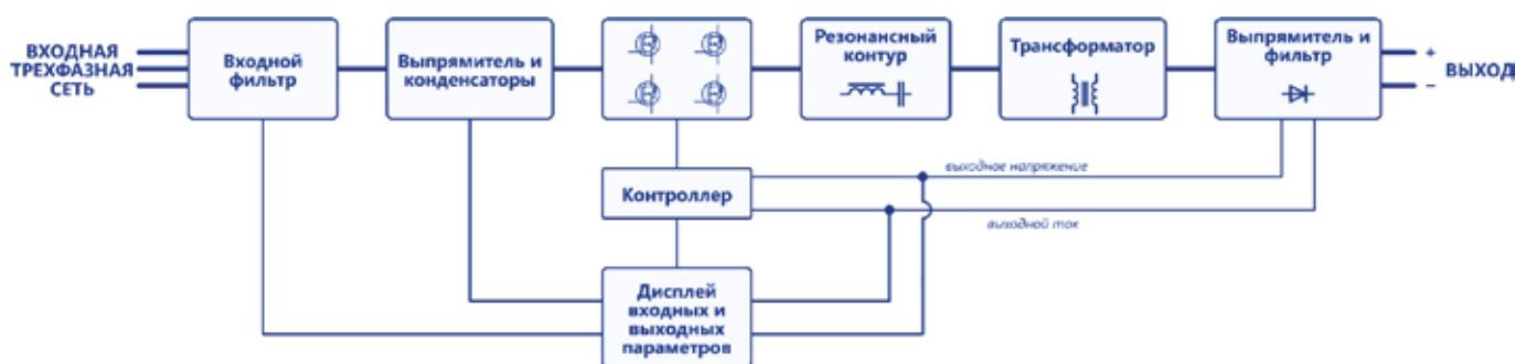
Рис. 7. Структурная схема одного модуля наборной силовой установки
