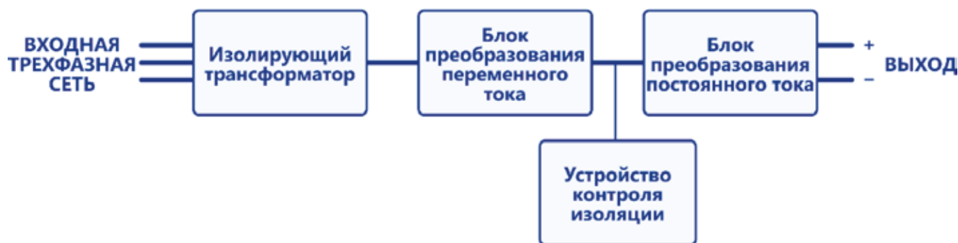
Рис. 5. Блок-схема понижающего преобразователя постоянного тока
