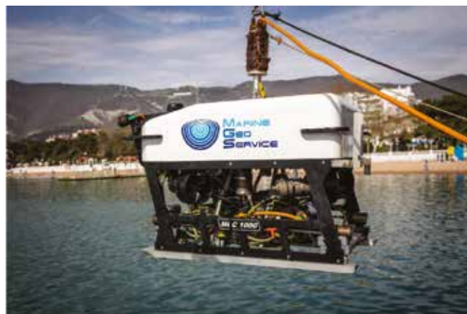
Рис. 2. ТНПА МСС-1000 с системой электропитания на постоянном токе (Marine Geo Service, Россия)
