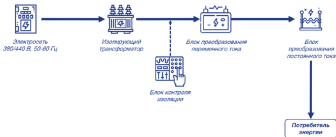
Рис. 3. Блок-схема системы электропитания ВИП 10К
