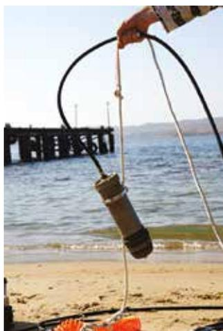
Рис. 1. Пневмоизлучатель
