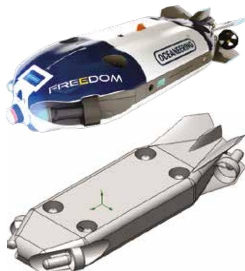
Рис. 3. Внешний вид ГНПА «Freedom ROV» и 3D-изображение его модели
