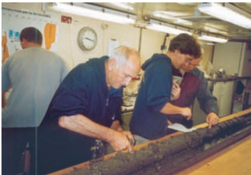
Рис. 2. Керна донных осадков, которые уже разрушены в результате деструкции газогидратов при температуре и давлении в лаборатории. Белые кусочки — это остатки слоев и (или) фрагментов газогидратов. Идет процесс отбора проб на анализ
