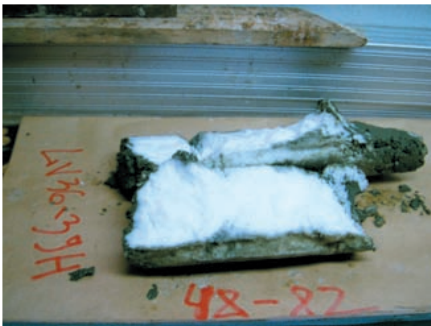
Рис. 12. Слой газогидрата, обнаруженный в донных осадках Сахалинского северо-восточного склона Охотского моря в интервале глубины 48–83 см от поверхности дна. Место расположения см. квадрат на рис. 1
