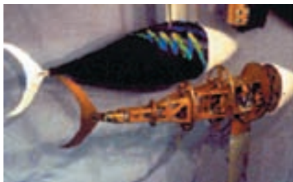
Рис. 2 Рыбообразный САНПА «Robotuna» с гибким корпусом и плавниковым движителем фирмы «iRobot» (Massachusetts Institute of Technology, США)
