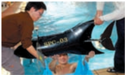
Рис. 3 Робот-рыба; совместная разработка Института робототехники при Пекинском университете авиации и космонавтики и Института автоматизации при Академии наук Китая
