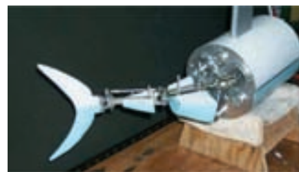
Рис. 7 Привод хвоста-двигателя рыбы-робота «PF600»
