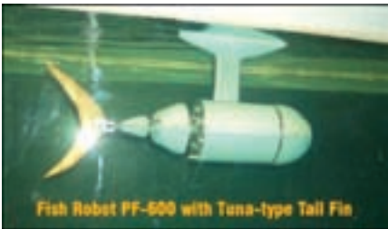
Рис. 9 Экспериментальный образец-прототип рыбы-робота «PF600», National Maritime Research Institute (NMRI), Токио
