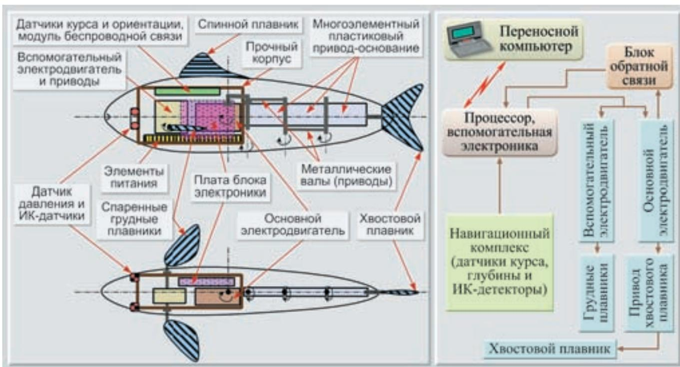
Рис. 19. Основные элементы конструкции АПМА МТ1
