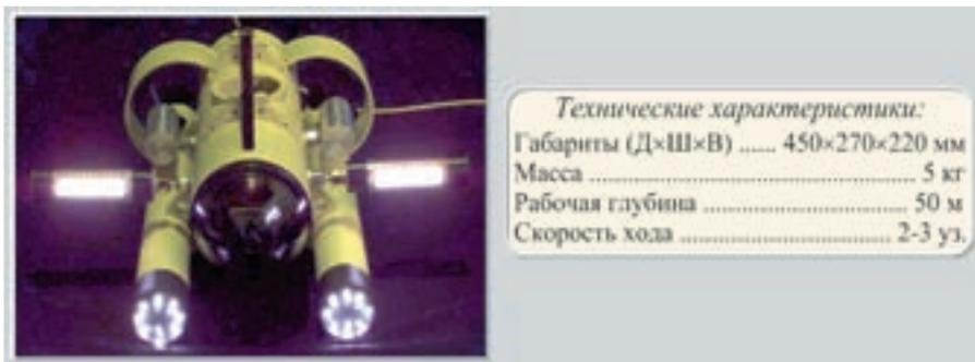
ПМА серии LBV 150/300 (рис. 5), разработанный компанией «SeaBotix», США. Масса аппаратов составляет ~11–13 кг (в зависимости от комплектации и рабочей глубины). Их стоимость колеблется от 13 до 40 тыс. дол. США.
