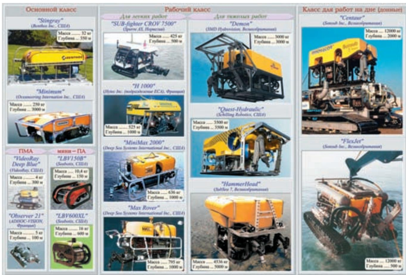
Рис. 2. Внешний вид современных неавтономных НПА различных классов
