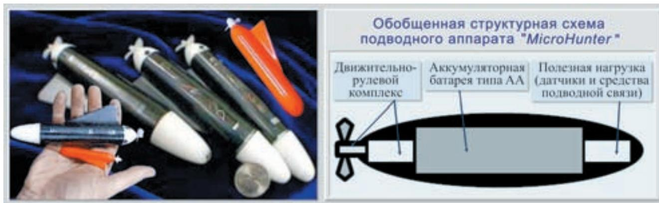
Рис. 16. Внешний вид макетных образцов подводных микроаппаратов серии «MicroHunter»
