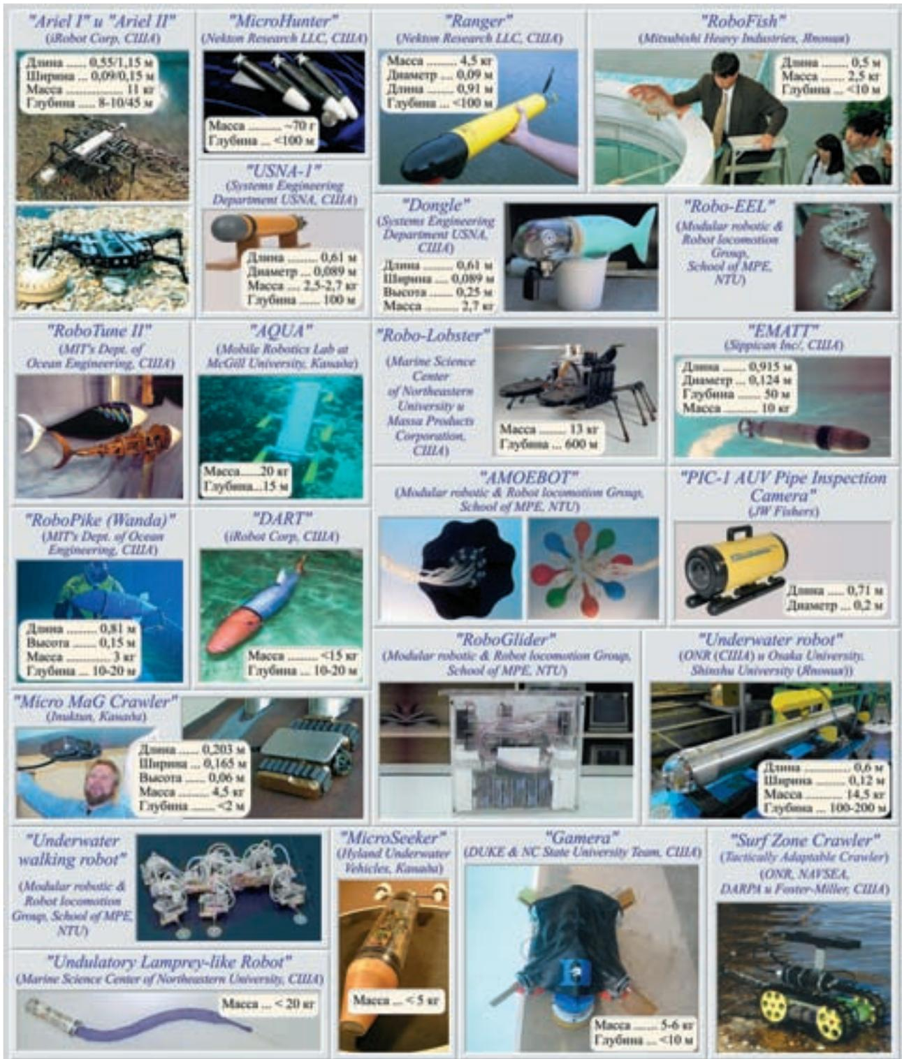
Рис. 15. Внешний вид проектов автономных подводных микроаппаратов и микророботов
