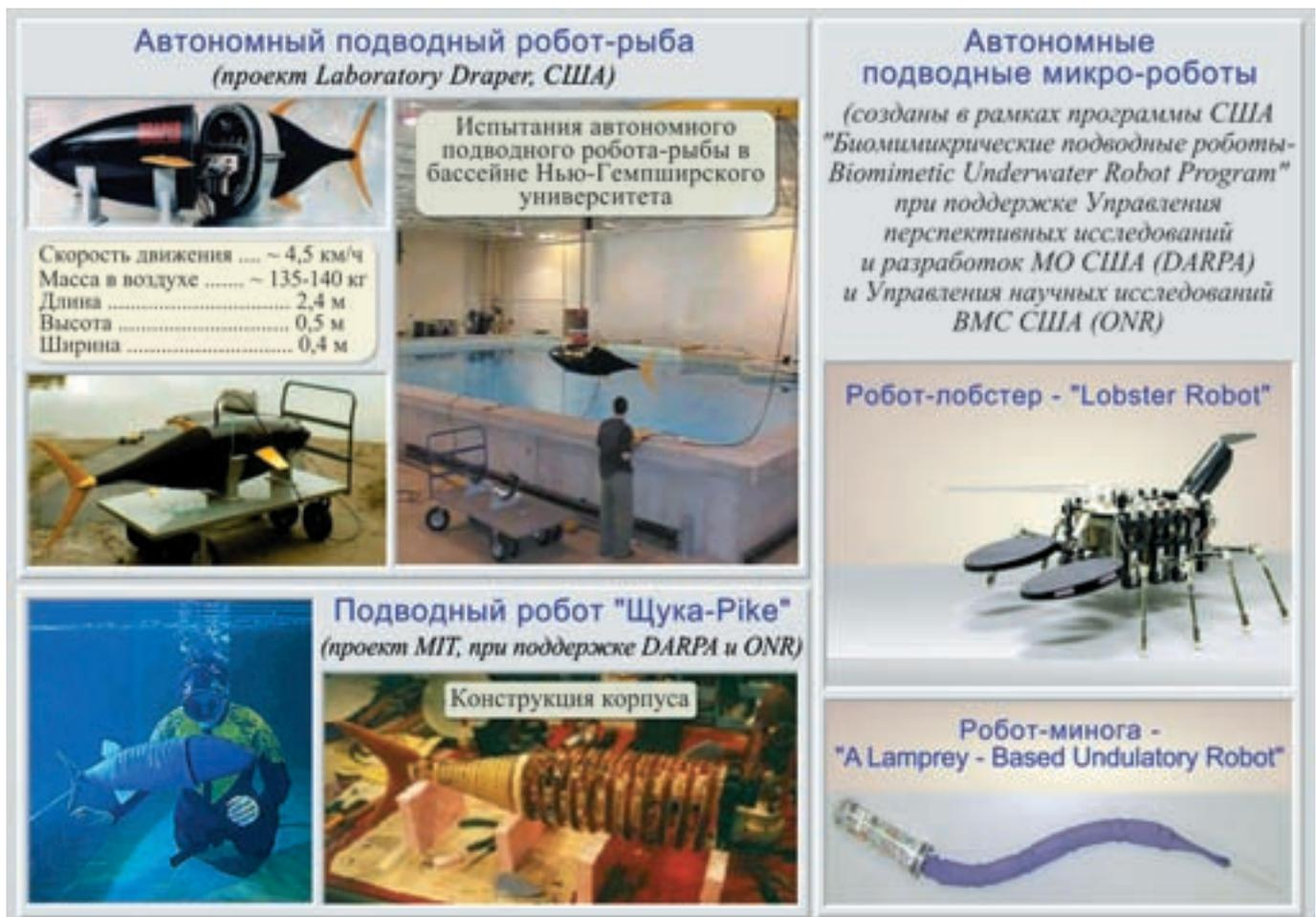
Рис. 17. Внешний вид автономных подводных роботов, разработанных в ходе реализации научно-исследовательских программ США
