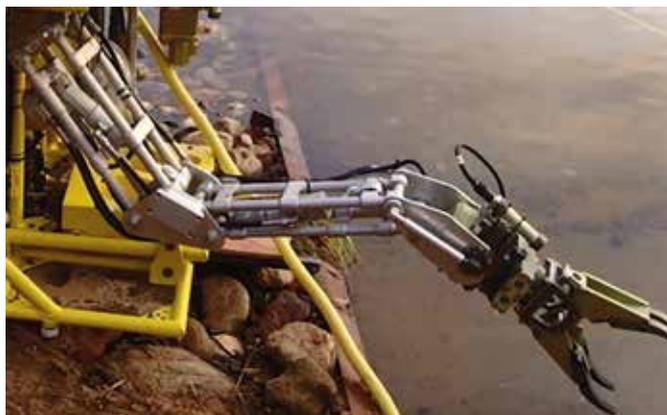
Рис. 1. Фотография подводного манипуляционного робота со звеньями пантографного типа для изделия «Водолаз»
