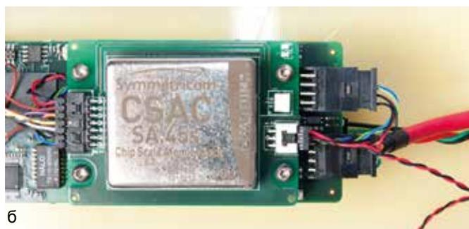
Рис. 6. Электроника г/а модема S2CM18/34OEM: а – фотография модема со всеми компонентами, включая SCAC SA.4s; б – размещение модуля цезиевых часов на плате вычислителя г/а модема
