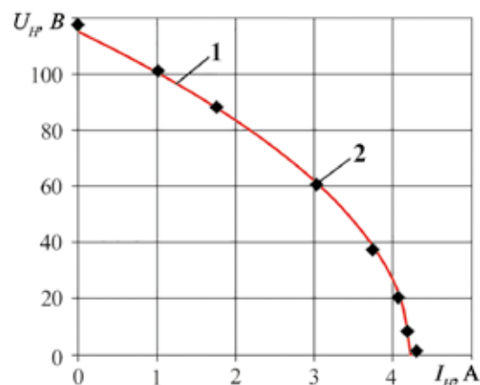
Рис. 7. Внешние характеристики системы бесконтактной передачи электроэнергии: 1 – аналитический расчет; 2 – натурный эксперимент
