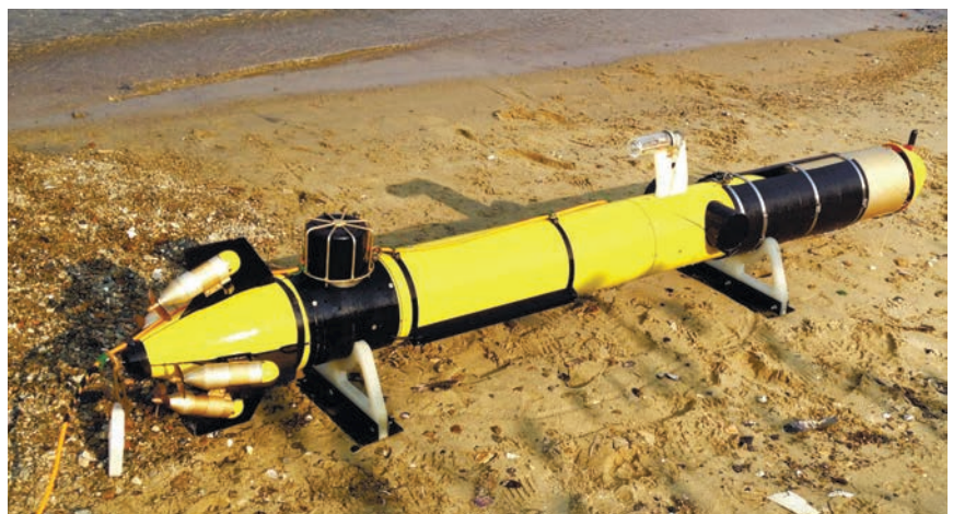
Рис. 1. Аппаратный комплекс на основе АНПА MARK
