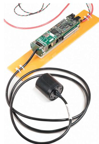
Рис. 3. Гидроакустический модем Evologics S2C M 18/34
