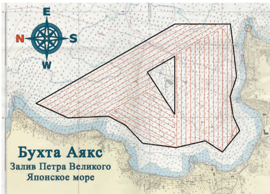
Рис. 5. Траектория покрытия бухты Аякс, сгенерированная алгоритмом
