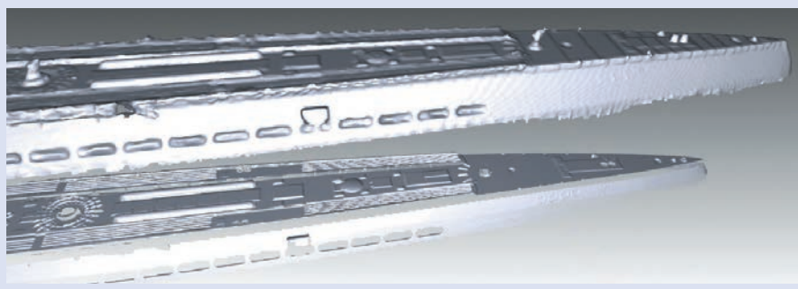
Рис. 12. Сравнение фрагментов модели 2. Снизу без зашивки дыр, сверху с зашивкой
