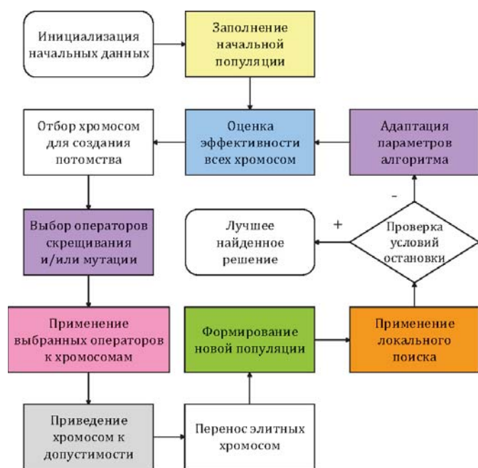
Рис. 4. Блок-схема предложенного гибридного эволюционного алгоритма. Цветом выделены оригинальные блоки алгоритма и авторские модификации известных процедур
