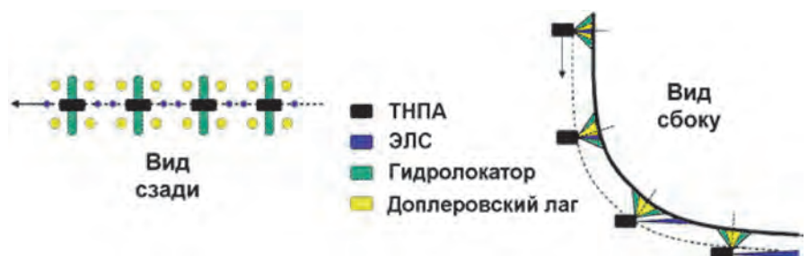
Рис. 11. Схема ориентации диаграмм направленности ЭЛС, ДЛ и профилирующего ГСО относительно инспектируемой поверхности
