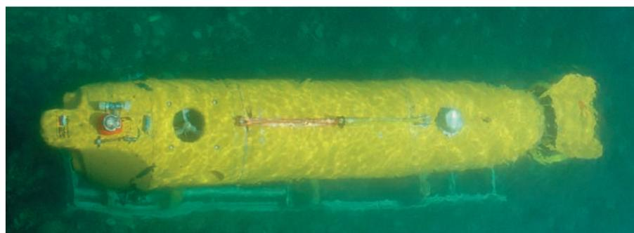
Рис. 11. ПА TSL выполняет посадку на раму, имитирующую доковое устройство
