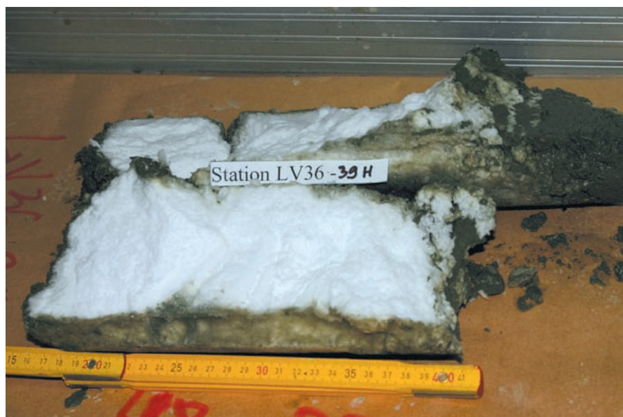
Рис. 2. Образец снежно-белого гидрата метана (длина 34 см) из гидростатического пробоотборника ГСП-2. Структура КОПРИ. Проект ХАОС II, 2005. Интервал 48-82 см. Отбор выполнен Крайниковым Г.А., ТОИ ДВО РАН
