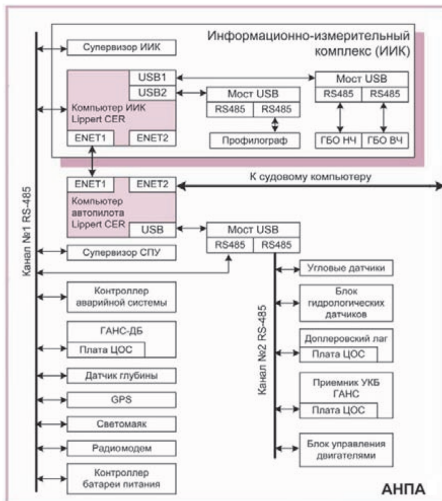
Рис. 4 Структура ЛВС АНПА «ММТ-2000»
