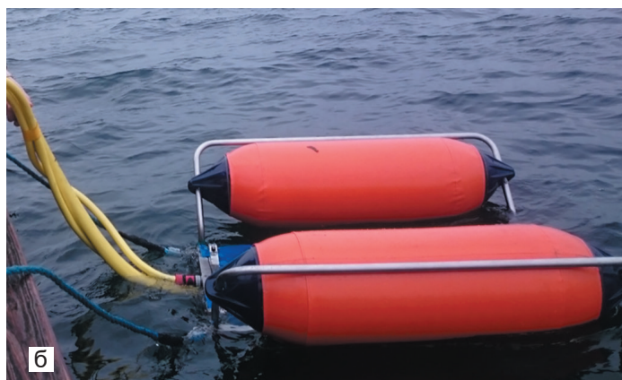
Рис. 6. Оборудование спаркера, использованное в тестах на г/а совместимость: а – генератор широкополосных импульсов, б – источник питания и излучатель широкополосных импульсов
