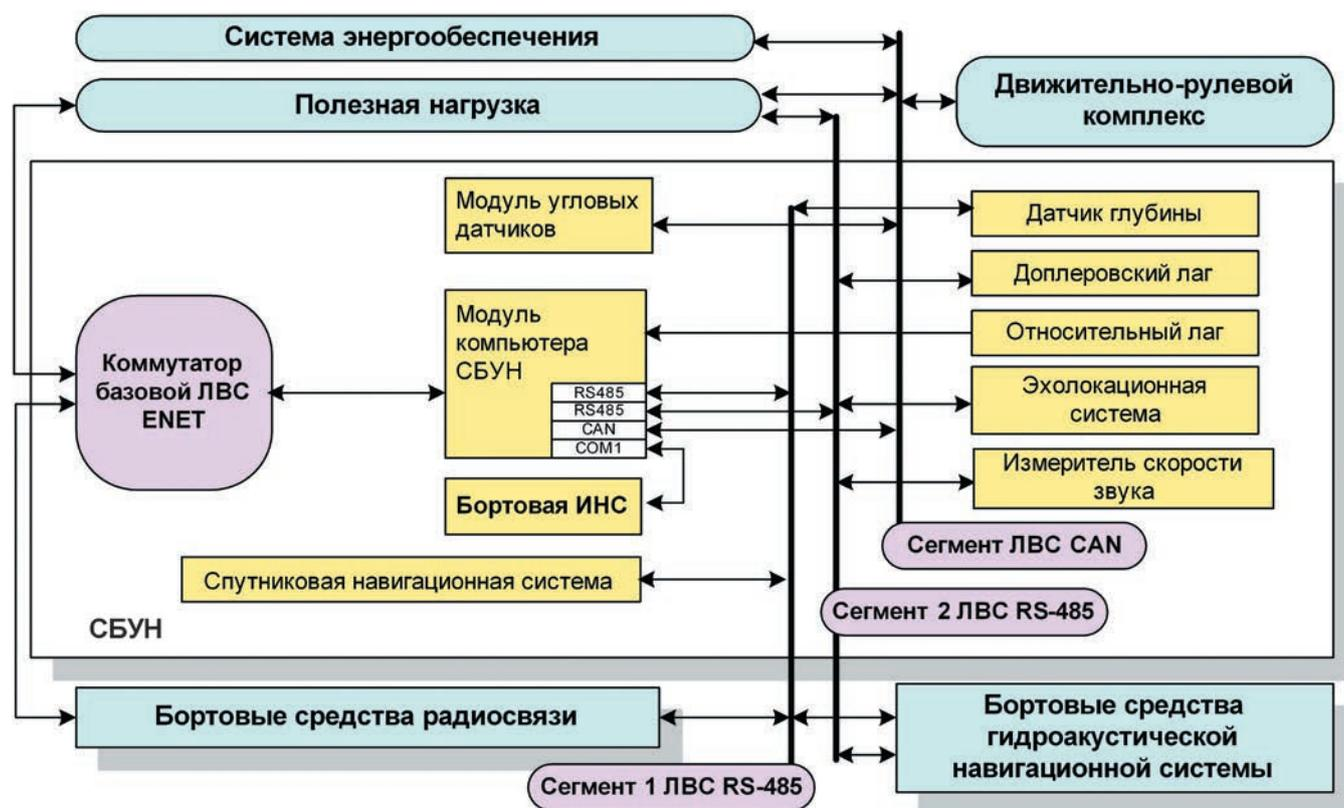
Рис. 4. Типовая структура СБУН
