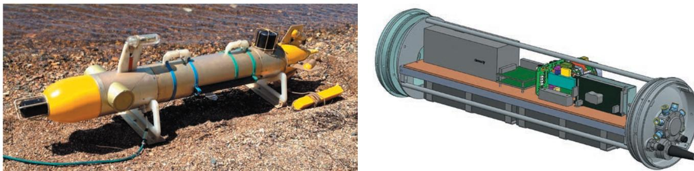
Рис. 6. Внешний вид АНПА «МАРК» и блок электроники СБУН, СЭО и ГАСНС (D 200 × L 700) – центральный отсек
