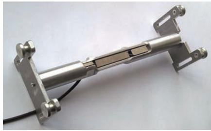
Рис. 7. Экспериментальная антенная секция в макетном исполнении
