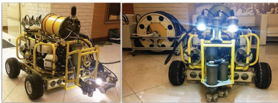
Рис. 9. Внешний вид ТНПА с гибридным движительным комплексом
