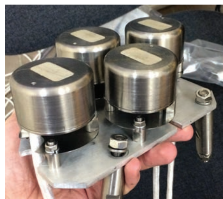
Рис. 8. Общий вид акустической подвески с четырьмя ЭМАП
