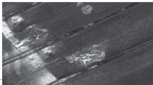
Рис. 14. Выходы потоков метана из донных отложений в воду на сахалинском северо-восточном склоне (слева, черные точки) и нарушение донных осадков в районе выходов пузырей метана из донных отложений в воду (справа, светлые округлые фигуры). Зафиксировано в результате сонарной съемки
