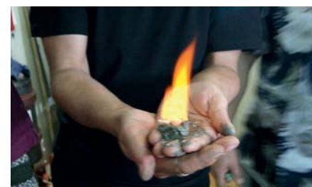
Рис. 17. Горит метан, который выделяется из газогидратов в атмосферных условиях. Газогидраты являются альтернативным энергетическим и (или) химическим сырьем
