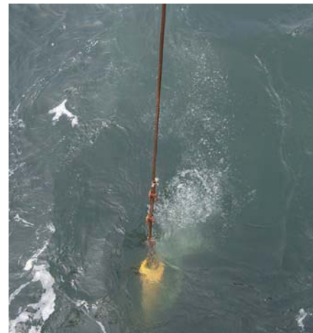
Рис. 13. Выделение метана из геологической трубки, содержащий керн донных осадков с газогидратами. При подъеме трубки с керном, содержащим газогидрат, и при достижении глубины около 200 м в связи с уменьшением давления газогидрат разрушается, и при подъеме к поверхности из трубки высвобождается метан в виде потока пузырей
