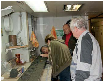
Рис. 12. Хитоши Соджи – координатор экспедиции с японской стороны – слушает, как трескаются разрушающиеся микрокристаллы газогидратов в донных осадках в керне станции LV56-31. Им дано название нанокристаллы. А.Н. Деркачев, Н.А. Николаева, Б.В. Баранов наблюдают за Хитоши. Охотское море, рейс № 56, 2011 г.
