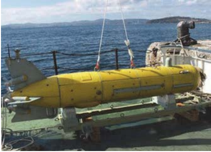
Рис. 2. АПР «Пилигрим». Подобный аппарат предполагается оснастить гидролокатором переднего обзора
