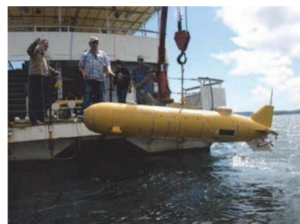
Рис. 1. АПР ММТ-2012 с установленным многолучевым эхолотом GeoSwath
