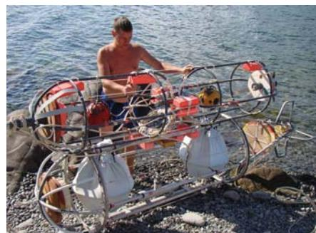
Рис. 2. Общий вид комбинированного приемного модуля без обтекателя
