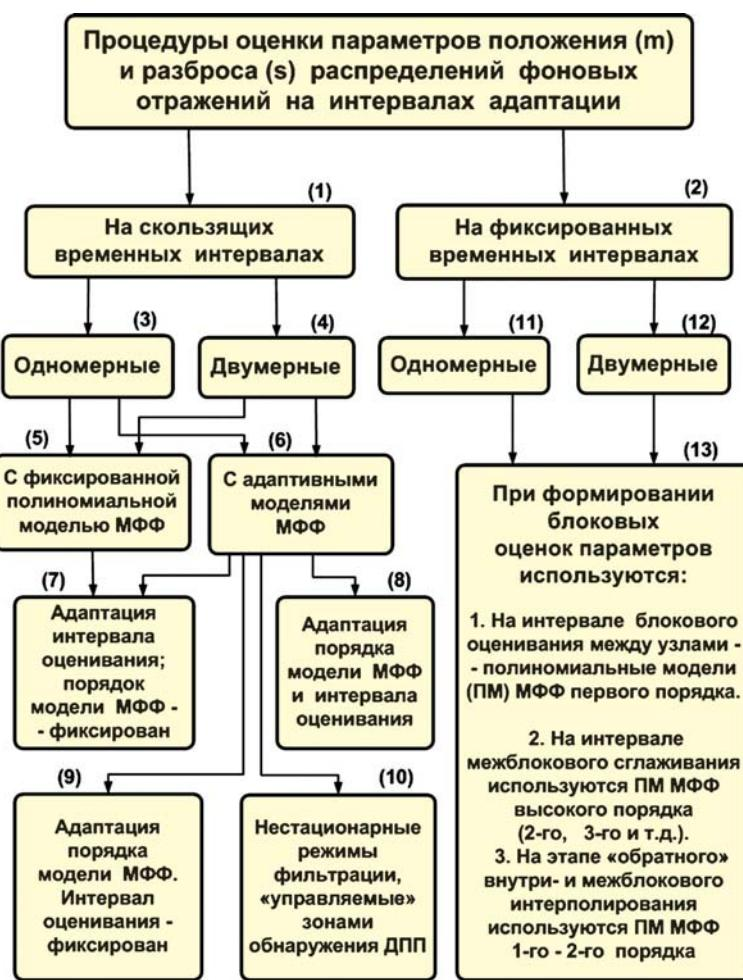
Рис. 6. Классификация процедур оценивания параметров положения и разброса распределений фоновых отражений на интервалах адаптации
