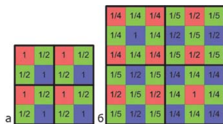
Рис. 3. Объединения ячеек матрицы фотокамеры в пиксели (цифрами указаны веса соответствующего цвета в пикселе): а – размером 2 \times 2 ; б – размером 3 \times 3
