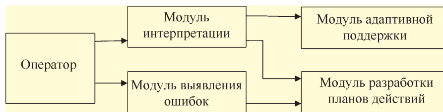
Рис. 5. Блок-схема интеллектуального интерфейса оператора (ИИО)
