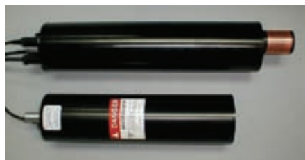
Рис. 1. Общий вид УФ спектрофотометра (вверху – спектрофотометр ISUS V3, внизу – блок питания для спектрофотометра) [7]
