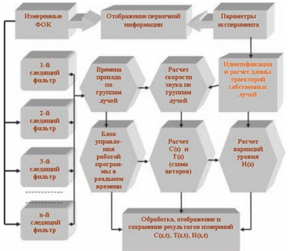
Рис. 4. Блок-схема программы измерения и мониторинга параметров среды
