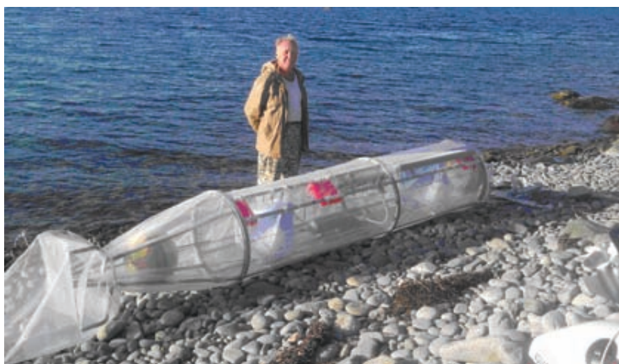
Рис. 3. Восемиканальный приемный комбинированный модуль нейтральной плавучести. Японское море, бухта Витязь
